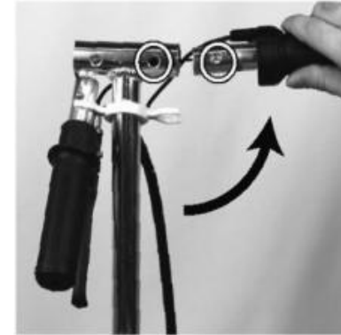
umieść prawą i lewą rączkę kierownicy w pałaku i unieruchom je – kulka pozyc
